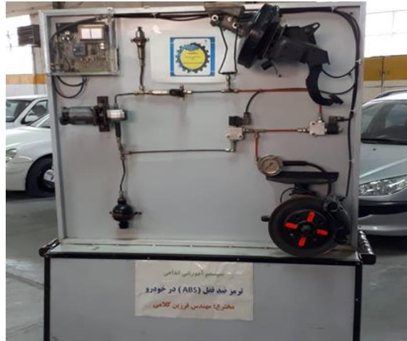
ساخت سیستم آموزشی ترمز ضد قفل هیدرولیکی در خودرو آموزشکده شهید یزدانپناه
